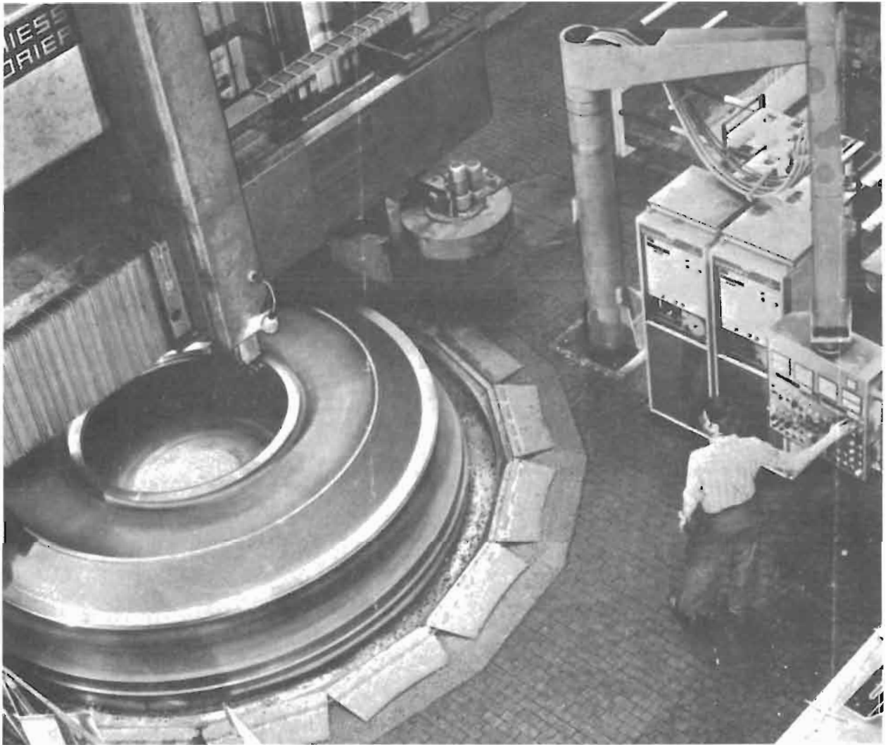
Fig. 12/1 - Torno a giostra controllato numericamente per la lavorazione di grandi parti rotanti. A destra il pendolo di comando per l'introduzione manuale degli ordini di controllo e pannello di comando per l'introduzione dei dati numerici per mezzo di nastri perforati.
